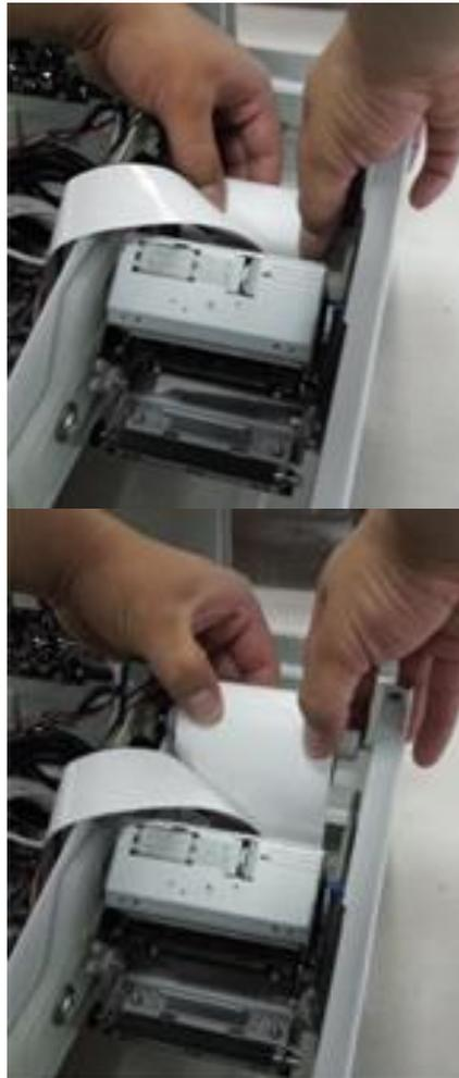
7. El rollo de papel tiene un par de tornillos y argollas de plástico que lo sostienen al mecanismo de la impresora. Retire las argollas de plástico para sacar el rollo de papel.
