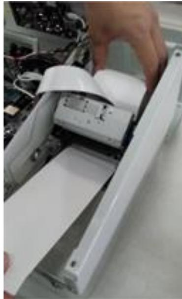
13. Coloque el rodillo que cuelga por enfrente de la impresora, debajo del cabezal de la impresora, insertando los tornillos laterales en las ranuras que le corresponden, presione la parte metálica suavemente hacia abajo y jale hacia atrás el papel, deberá escuchar un “clic” que fija el rodillo al mecanismo de la impresora.
