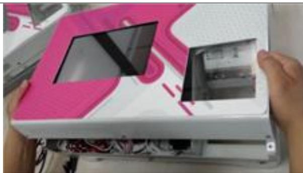
3. Coloque la carcasa detrás de la urna, cuide que no se tensen ni se desconecten los cables de la pantalla.
