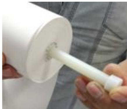
9. Libere el papel del pegamento que sostiene la hoja. El área de impresión del papel debe de quedar hacia arriba. Jale el papel hacia el frente, aproximadamente 10 centímetros para poder colocarlo.
