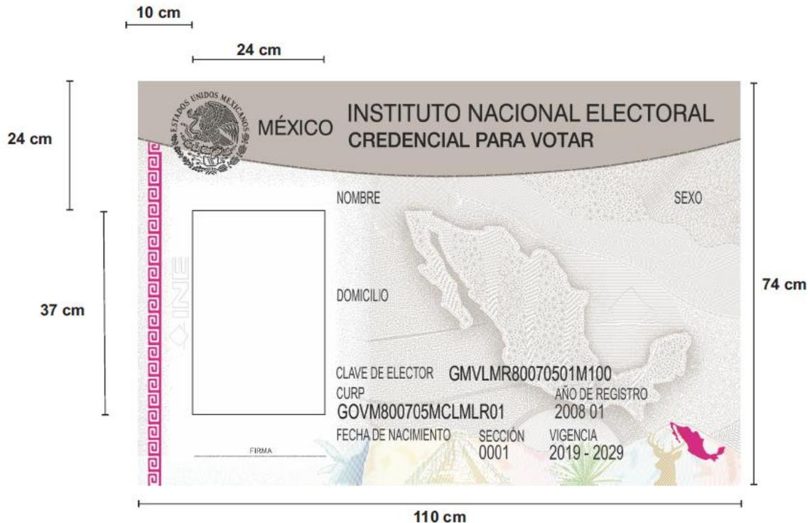
PVC espumado rígido de 3 mm. de espesor con una medida total de 74 x 110 cm. forrado con vinil autoadherible blanco, impreso en CMYK a 1200 DPI conforme a diseño original entregado por el área usuaria, con protección de laminado mate. Suaje al interior de 37 x 24 cm. a una distancia del borde superior de 24 cm. y a 10 cm. del borde izquierdo.
