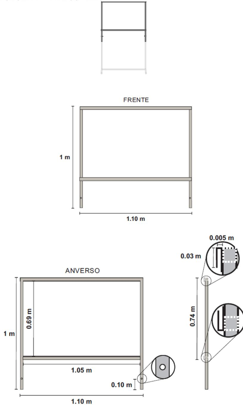
Estructura tubular superior de 1", con una medida de 1 x 1.10 m. Un tubo horizontal a una distancia de 0.69 m. del tubo superior. Una perforación para tornillo de 1/4" en ambos tubos laterales del frente hacia atrás, a 0.10 m de la parte baja del tubo al centro de la perforación. Al frente dos cejas metálicas de 0.03 x 1.10 x 0.005 m. en forma de canaleta, colocadas una en el tubo horizontal superior y la otra en el tubo inferior. Pintura electroestática Pantone 400 C.
